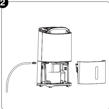
Nehmen Sie das rechtwinklige Verbindungsstück aus dem Deckel des Wasserbehälters und schieben Sie es auf den Ablauf. Der Ablauf ist die Stelle, an der das Wasser aus dem Luftentfeuchter tropft. Er befindet sich auf der linken Seite.
