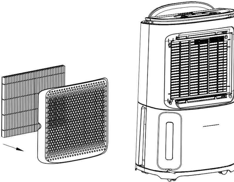
Der Luftentfeuchter wird mit einem kostenlosen HEPA-Filter der Klasse H13 geliefert. Dieser HEPA-Filter kann in den Luftentfeuchter eingesetzt werden, um eine Luftreinigung zu ermöglichen. Dies ist jedoch optional – der Luftentfeuchter kann auch ohne den HEPA-Filter verwendet werden, d. h. er entfeuchtet die Luft nur und reinigt sie nicht.
