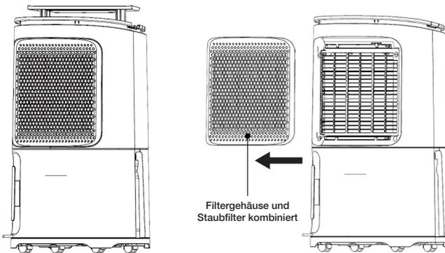
Der Staubfilter ist ein Filter mit langer Lebensdauer und sollte daher nicht ausgetauscht werden müssen (außer aus Verschleißgründen). Bei regelmäßigem Gebrauch kann sich der Filter mit Staub und Schmutzpartikeln zusetzen. Der Filter muss mindestens alle zwei Wochen gereinigt werden (andernfalls kann die Garantie für das Gerät erlöschen). Bitte befolgen Sie die nachstehenden Schritte.
