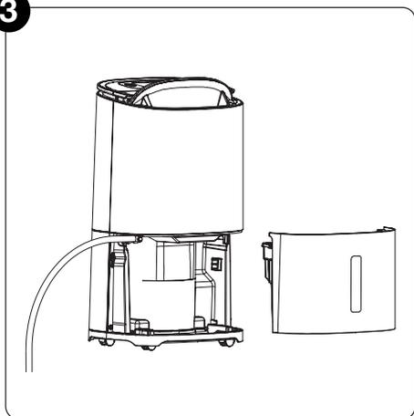
Befestigen Sie den Schlauch am Ablauf am Ablauf.
